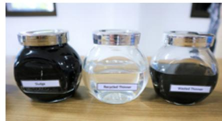
シンナーで洗浄した後の廃液（左）と溶剤再生装置で分離させた後のシンナー（中）、残渣（右）＝10月25日、タイ・チャチュンサオ県（NNA撮影）
